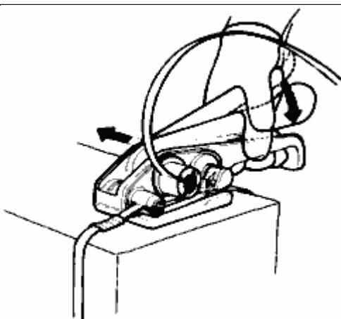
5. Раздвинуть рычаги зажимных клемм, установить клеммы над скобой, свести вместе рычаги зажимных клемм, до полного зажима скобы, после этого удалите клеммы.
